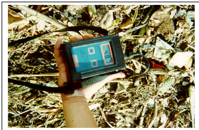
Foto 28 - Medição de Temperatura da Leira
